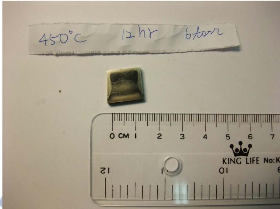
圖 4-3 450°C-12h-6torr 鐵鋁錳合金離子氮化後表面外觀。
