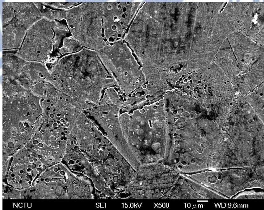
圖 4-28 450°C-12h-1torr 鐵鋁錳合金在 3.5%NaCl 水溶液中浸蝕 72 小時後 SEM 圖。
