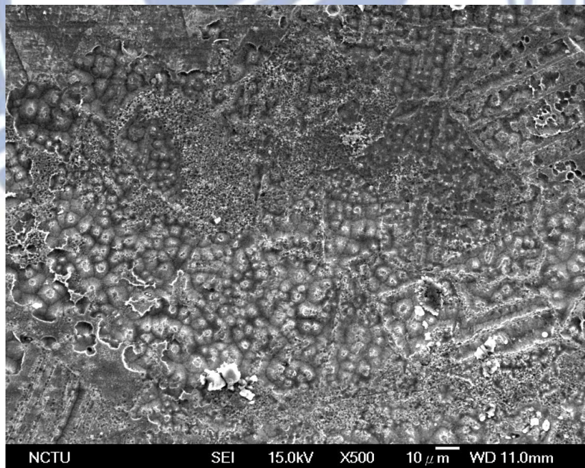
圖 4-20 450°C-12h-1torr 鐵鋁錳合金在 3.5%NaCl 水溶液中極化後 SEM 圖。
