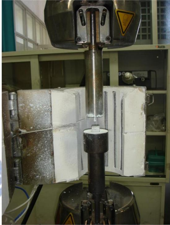
圖 2-5 Impression Creep Test 示意圖。
