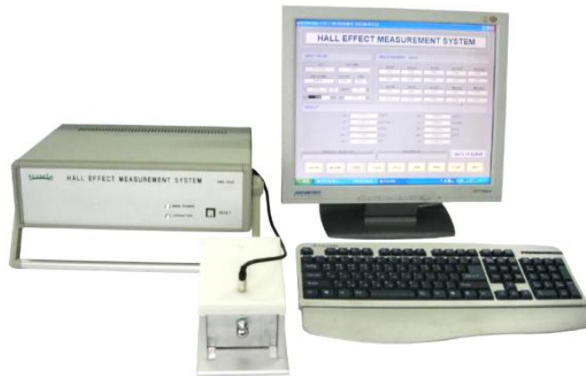
圖 3-4 Ecopia HMS-3000 霍爾量測系統。
