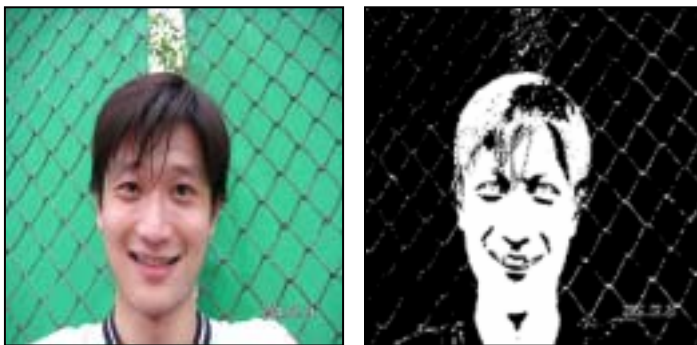
圖 3-4：左圖為待處理的彩色圖像，右圖為經 HSV 主體區域範圍選取而得的遮罩影像，右圖白色部份即為主體區域
