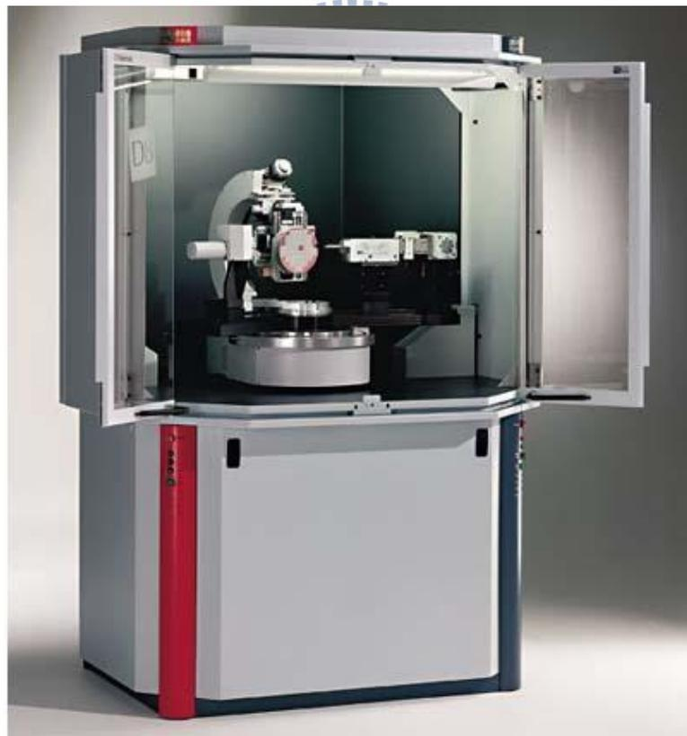
圖(3.2-1) Bruker AXS D8 ADVANCE 系統圖
