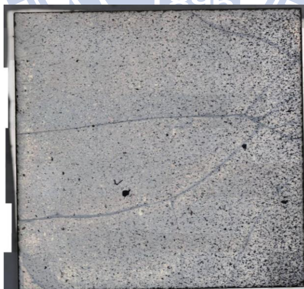
【圖 3-12】PMN-PT 壓合後的 OM 影像
