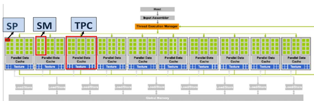
圖 2.2.1.1 GT200 架構示意圖：GT200 共有 240 個 SP，每個 SM 有 8 個 SP，每個 TPC 有 3 個 SM。 資料來源：文獻[12]。
