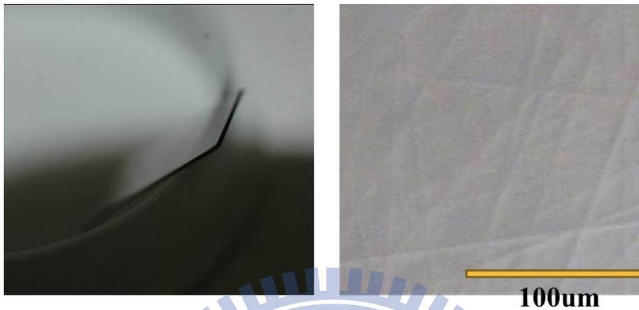
圖4-1-1-3 光學顯微鏡觀察拋光後的Ga-face表面，保有直角切邊
