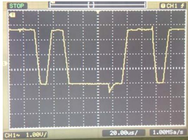
圖 3 - 3 放大後 a 字母在 True Format 下傳輸的波形 [21]
