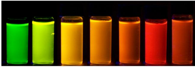
圖 32 在紫外光照射下，不同尺寸 GSH-capped CdTe 量子點之顏色 [39]
