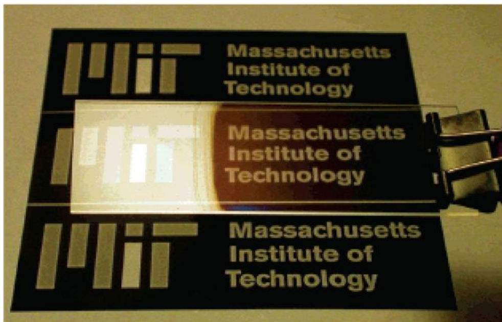
圖 2-20 塗有 5 層(7 nm TiO 2 /22 nm SiO 2 )奈米粒子結構之玻璃基板照片[15]
