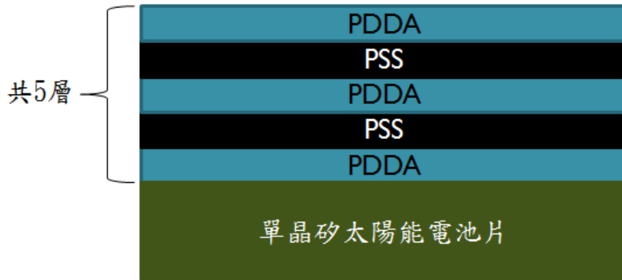
圖 3-6 完成五層界面活性劑塗佈的電池片示意圖
