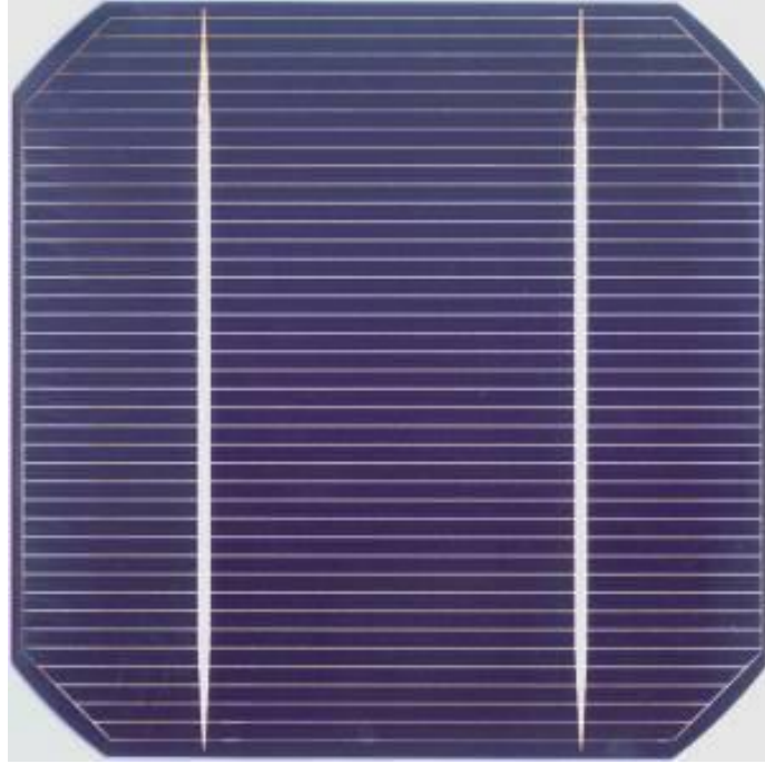
圖 1-1 經過粗糙化及氮化矽單層膜製程的單晶矽太陽能電池
