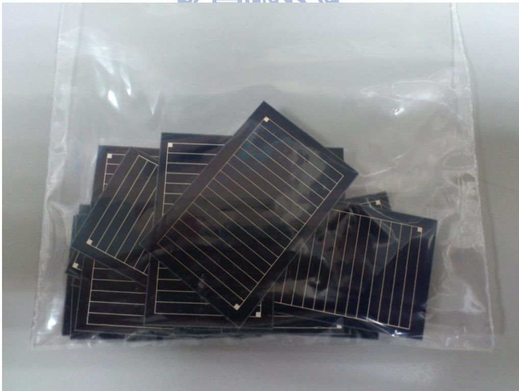
圖 3-2 工研院所提供的單晶矽太陽能電池片
