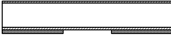
(d) poly-Si etching by RIE
