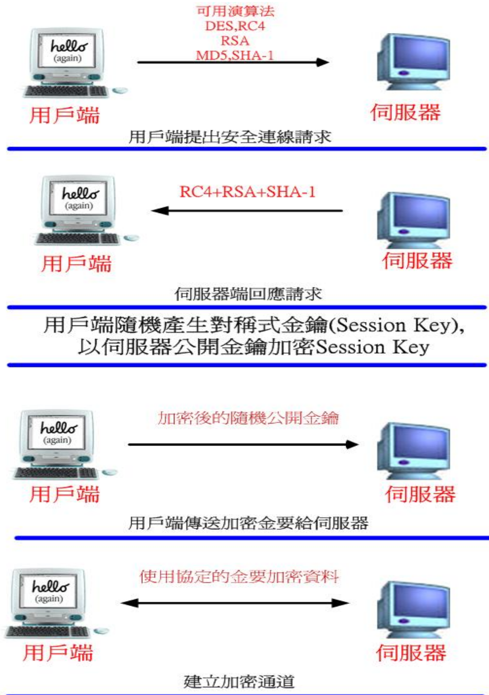
圖 2-11 SSL 連線 Handshake 流程
