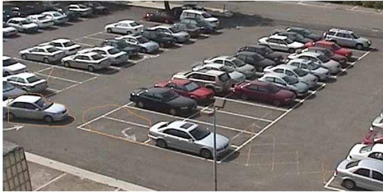
圖 3.19 經由前景偵測演算法在原先車輛停放的位置偵測出一個新的前景物體，開始監控此前景物體狀態變化。
