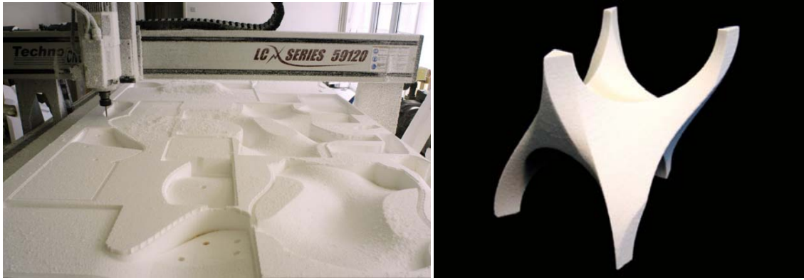
圖 36 CNC milling machine(左)；圖 37 Bone wall(右) (Macdonald, 2006)
