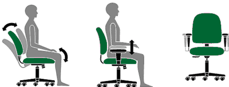
圖 44 椅背傾斜張力的調整(左)；圖 45 扶手與使用者坐姿關係(中、右)(the human solution, 2003)
