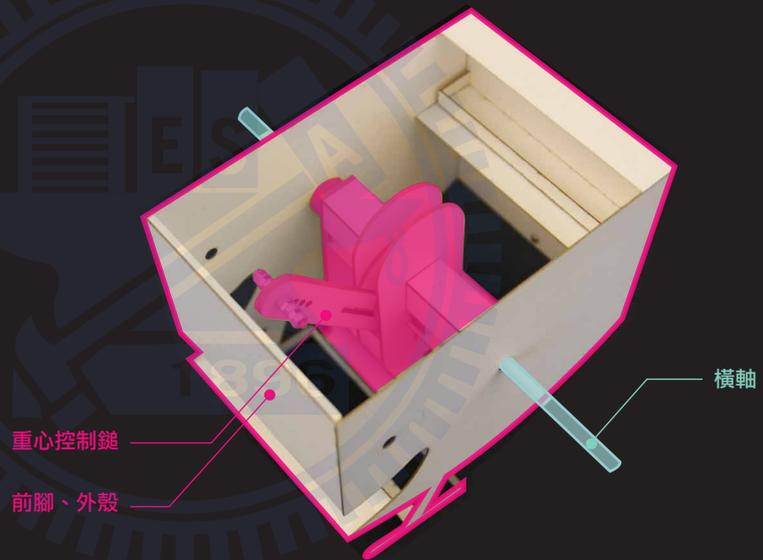
利用重垂的擺盪所產生的加速度與外殼的重量達到動態平衡的狀態，來造成整體玩具的擺盪前進。
