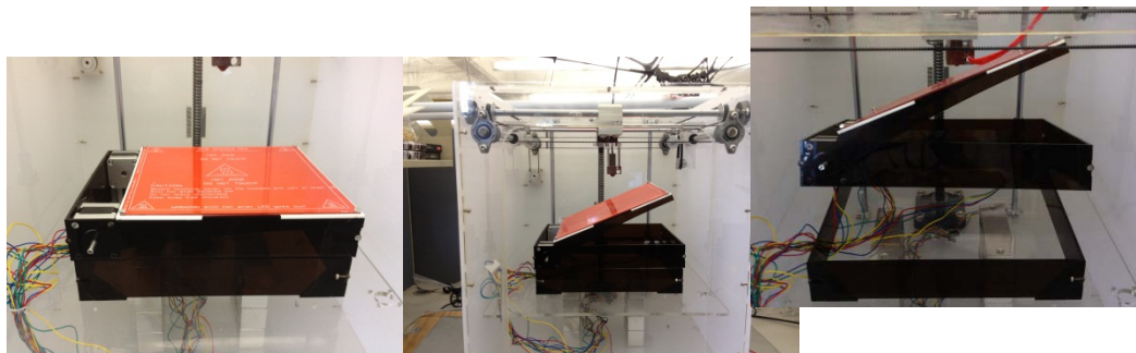
圖38. 傾斜生成平台上機模擬開闔
