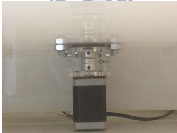
圖30. Z 軸步進馬達與聯軸器
