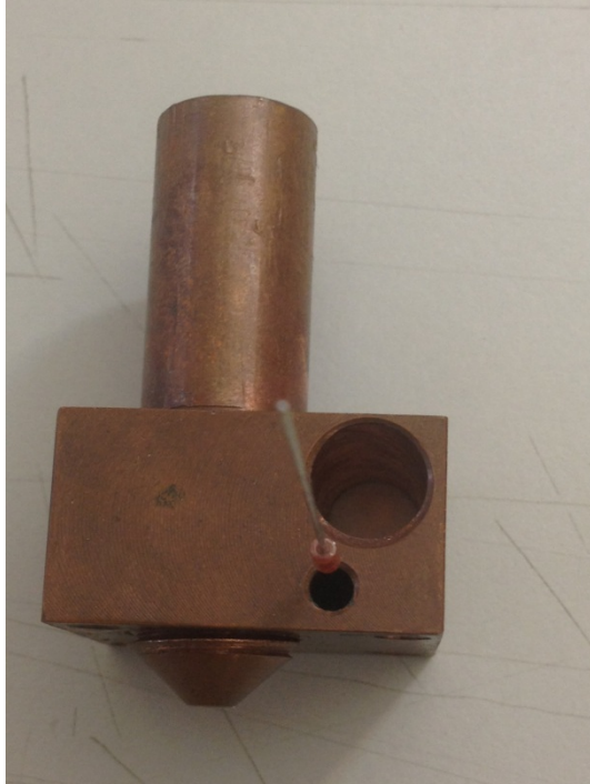
圖32. 擠出噴頭及加熱塊，加熱電阻，感溫電阻
