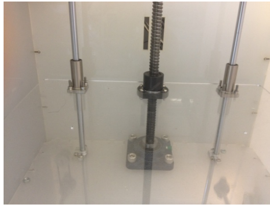
圖29. Z 軸使用滾珠螺桿
