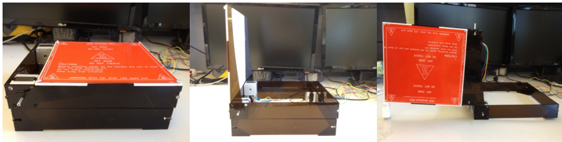
圖36. 傾斜生成平台可開啟最大角度 90 度
