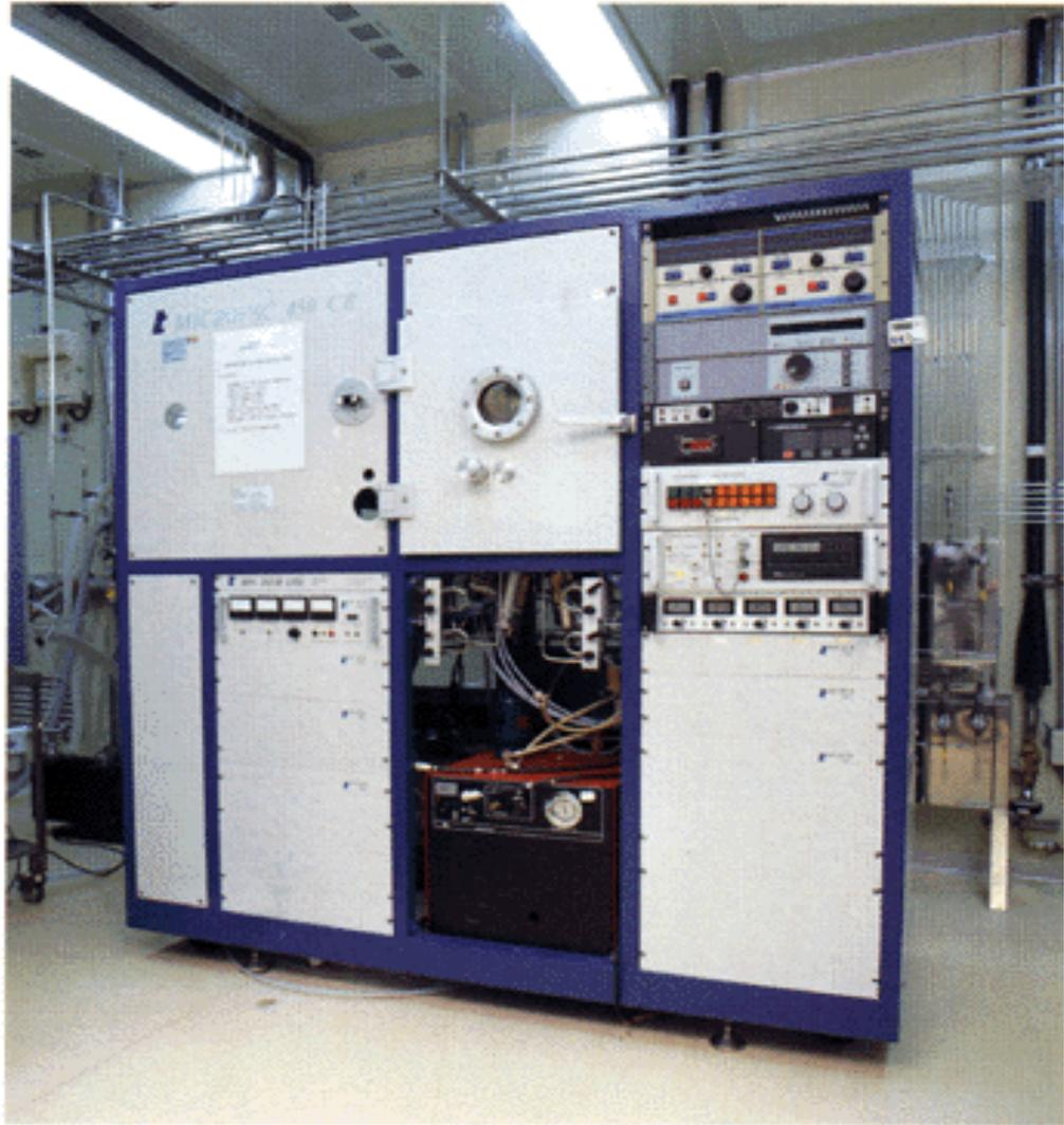
圖 3-2 英國 Ion Tech Microvac 450CB 真空濺鍍系統。
