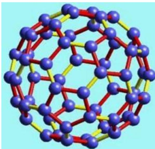
圖 2-1 富勒烯結構示意圖 [\[http://nano.nchc.org.tw/\]](http://nano.nchc.org.tw/)。
