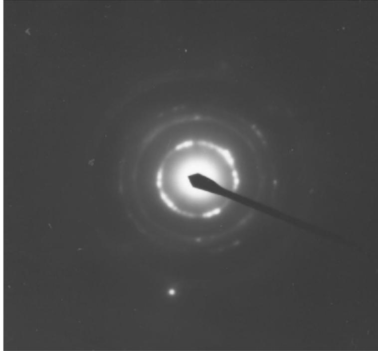
圖 4-10 碳奈米結構經 TEM 聚電子束後的電子繞射圖
