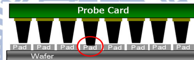
圖 3-6 OD1 探針與錫墊接觸示意圖
