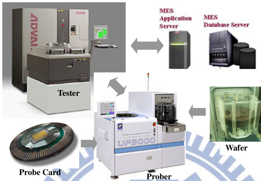
圖 2-5 晶圓測試系統架構圖 資料來源: A 晶圓測試廠提供
