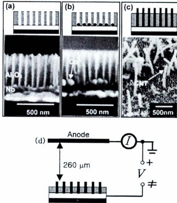
圖 2-1: CNT 場效發射體之製備 (a)在Nb/Si 基板上製備 AAO 模版;
