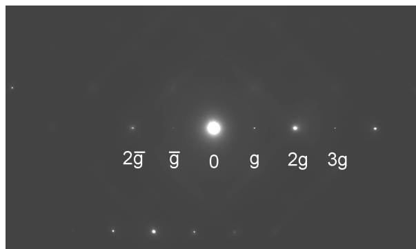
圖 5-3 真實弱電子束條件暗視野繞射影像。
