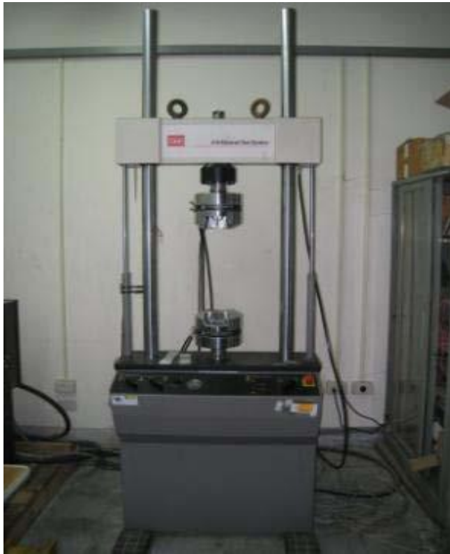
圖 3- 7 拉伸試驗機 MTS810 Material Test System
