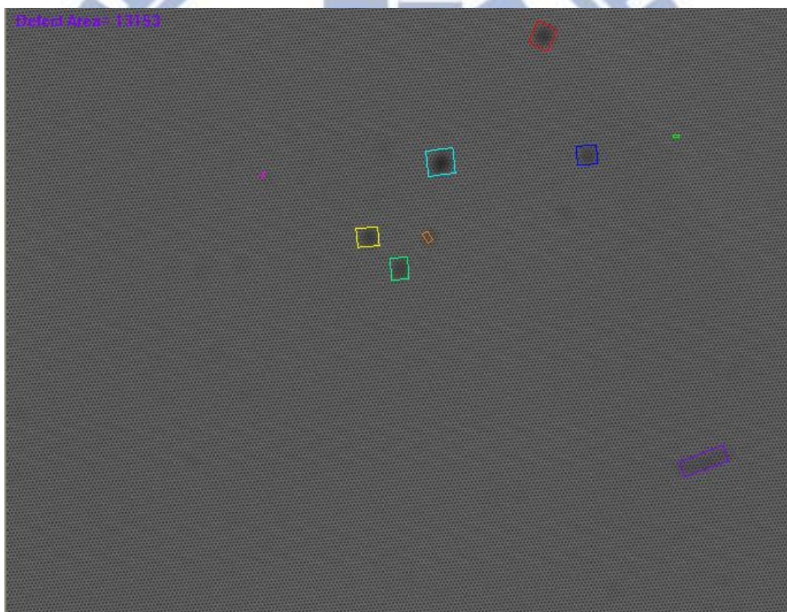
圖 4-9 最小包覆矩形演算法所產生之檢測結果
