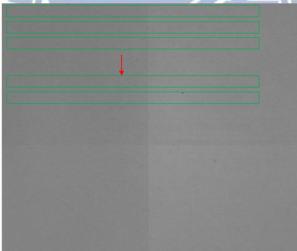
圖 4-12 利用水平切分導數求取水平格線
