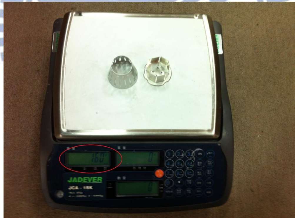
圖 4-1：Heat sink 重量量測圖
