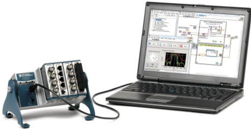
圖 3-2：溫度擷取器(NI cDAQ-9174) 資料來源： http://sine.ni.com/
