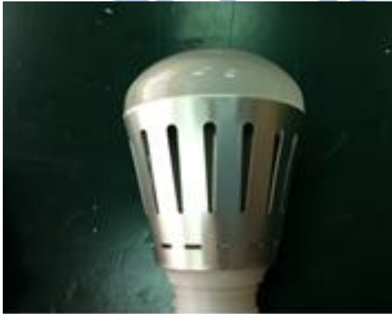
圖 3-10：實驗成品圖(Punching)
