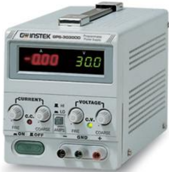
圖 3-1：電源供應器(GPS-3030DD) 資料來源： http://www.instek.co.jp/
