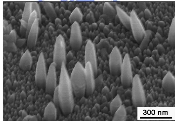
圖 4-15 編號 2-01 試片以 Si (100) /Au(10nm)為基板，選擇適當製程條件成長氧化鋅，成長時間為 60 分鐘，其傾斜 45°觀察不同倍率的 SEM 照片
