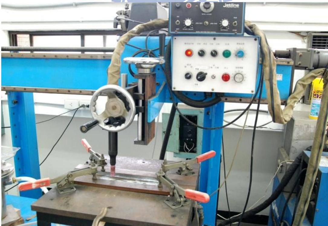
圖 3-4 Gullco – GK191-P/18A 型自動走銲機
