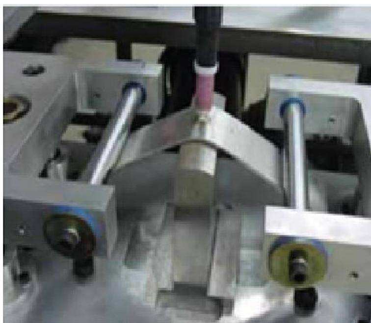
圖 3-5 可調式應變試驗 (Spot Varesstraint Test) 機
