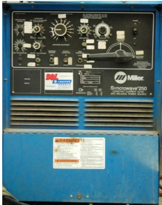
圖 3-3 Miller – Syncrowave 250 型惰氣鎢極電弧銲接機
