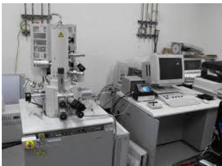
圖 3-10 高解析度場發射掃描式電子顯微鏡暨能量散佈分析儀
