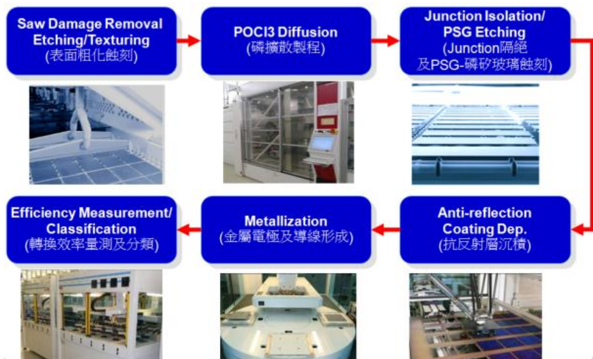
圖 4-1 太陽能電池片 Solar cell 製造流程示意圖
