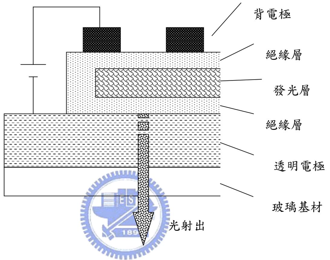
圖 1-1 (a) 無機電激發光元件基本構造
