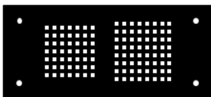
圖 19、鍍電極使用之金屬遮罩
