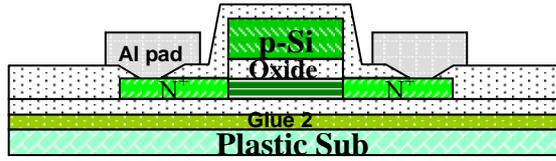
圖 2-6 薄膜電晶體二次轉移流程圖
