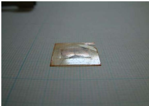
圖 3-17 一次轉移將元件轉移至塑膠基板上
