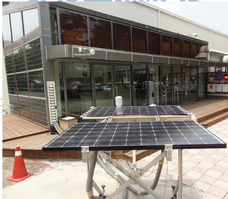
圖 5-2、Type-1 PV/T 系統現場測試平台
