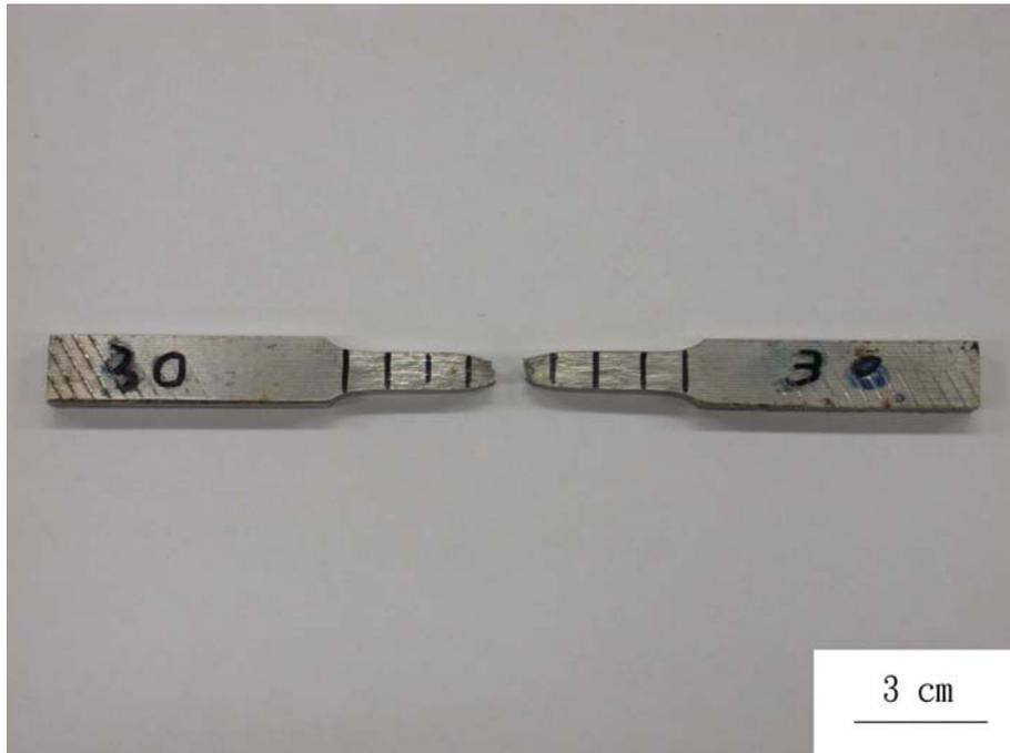
圖 8(a). 熱軋試片在  $1100^{\circ}\text{C}$ 、1.5 小時固溶熱處理後水淬經拉伸試驗斷裂後試片之相片。
