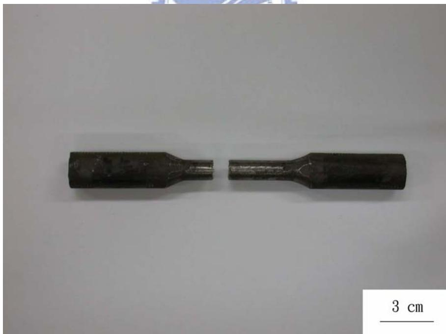
圖 7(b). 鑄造試片在  $1100^{\circ}\text{C}$ 、1.5 小時固溶熱處理再經過  $850^{\circ}\text{C}$ 、6 小時時效熱處理後水淬經拉伸試驗斷裂後試片之相片。
