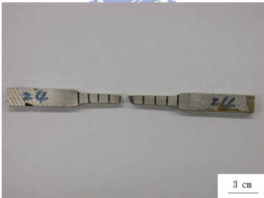
圖 8(b). 熱軋試片在  $1100^{\circ}\text{C}$ 、1.5 小時固溶熱處理再經過  $850^{\circ}\text{C}$ 、6 小時時效熱處理後水淬經拉伸試驗斷裂後試片之相片。
