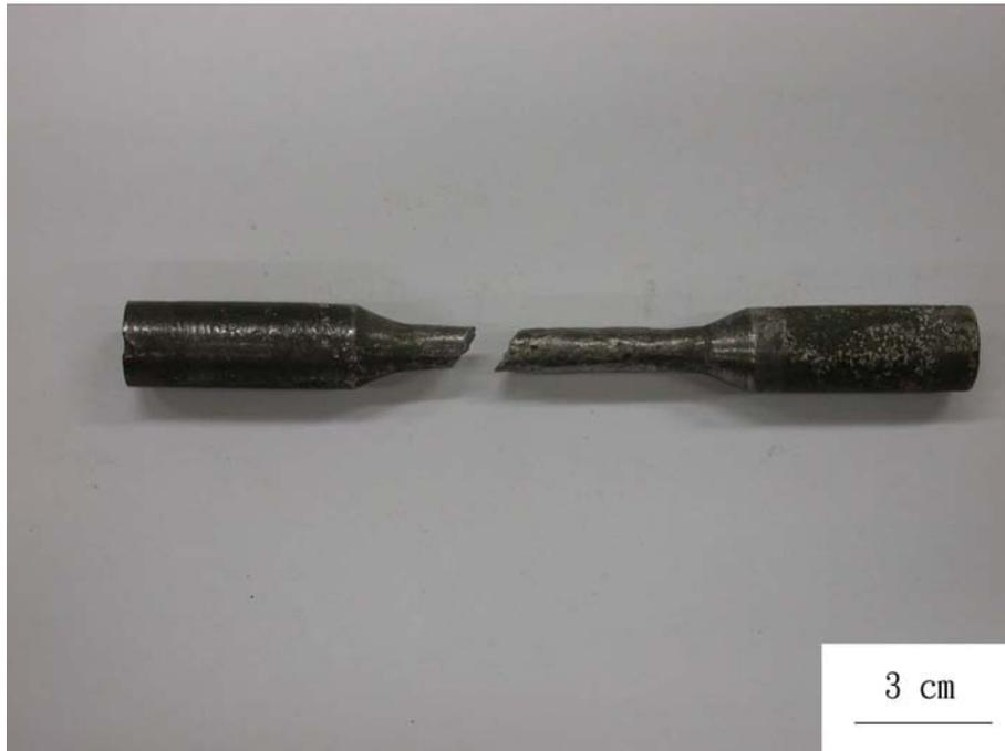
圖 7(a). 鑄造試片在  $1100^{\circ}\text{C}$ 、1.5 小時固溶熱處理後水淬經拉伸試驗斷裂後試片之相片。
