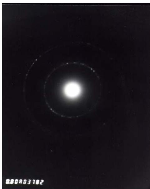
圖 4-6 PI/TiO<sub>2</sub> (10wt%) TEM 環狀繞射圖形
