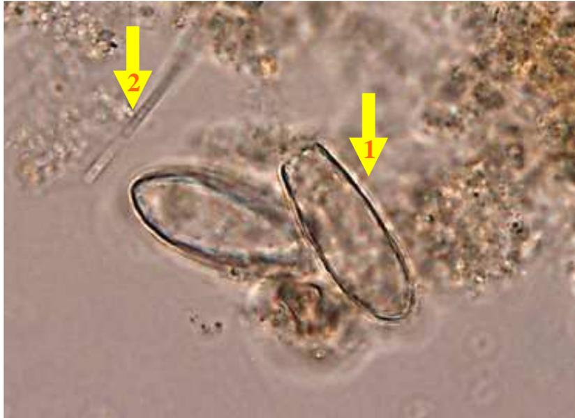
圖 5-12 BCR-C 除碳槽在體積負荷  $67 \text{ g TOC} / \text{m}^3 \text{ d}$  時之菌相(1000X)
