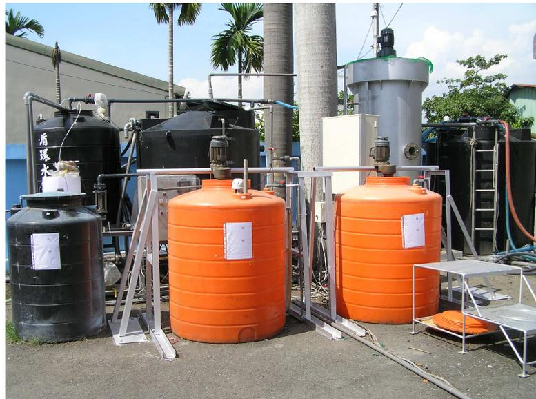
圖 3-8 模型廠之地下水生物脫硝實體裝置
