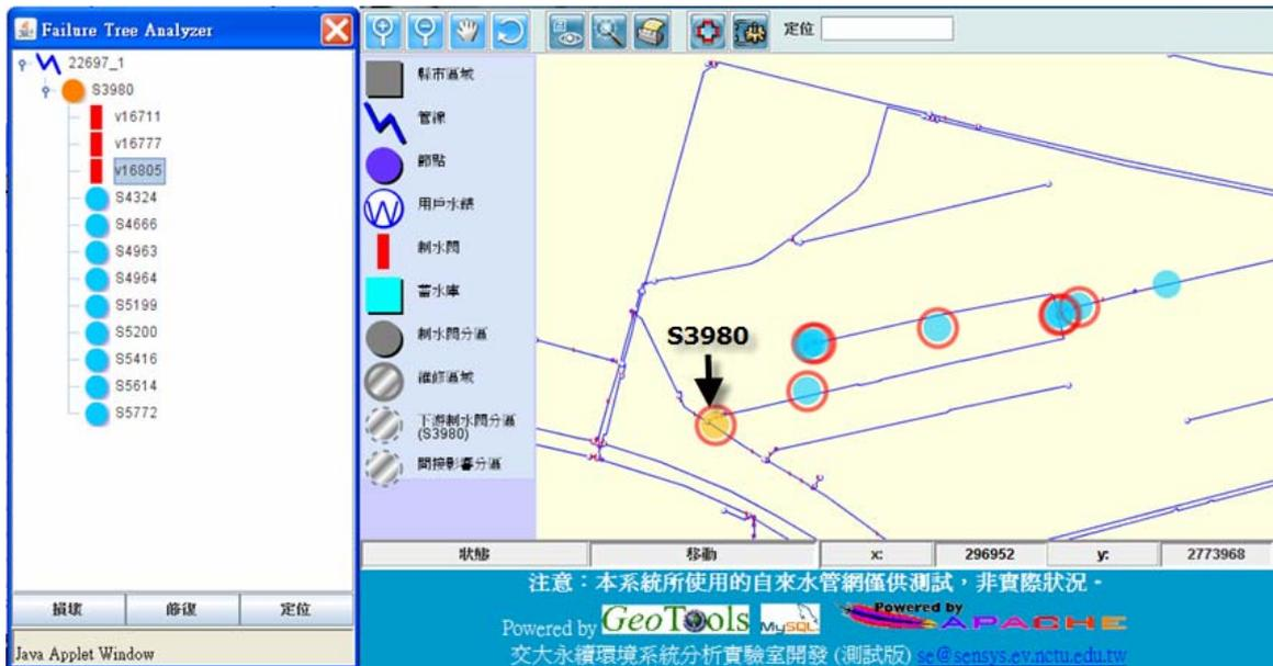
圖 5.17 應用管線損壞擴張樹分析管線損壞之範例畫面。箭頭所指為直接停水維修分區。
