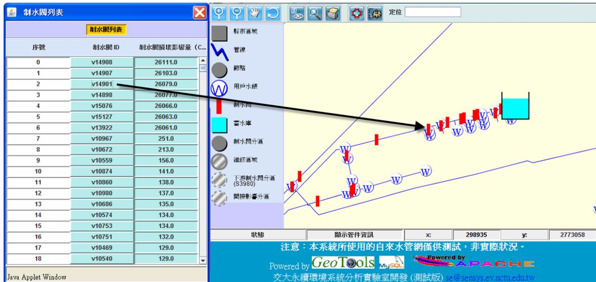
圖 5.22 具較大連通關鍵性制水閥 v14901 之空間定位結果。
