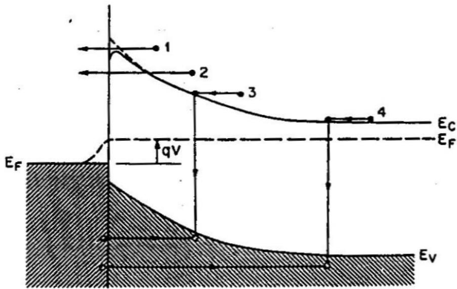
【圖 2-1】順向偏壓下蕭基二極體的四種電流傳導機制
