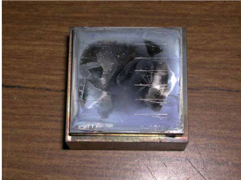
圖 3.24 壓印 10 次後模仁表面粘黏玻璃的情形
