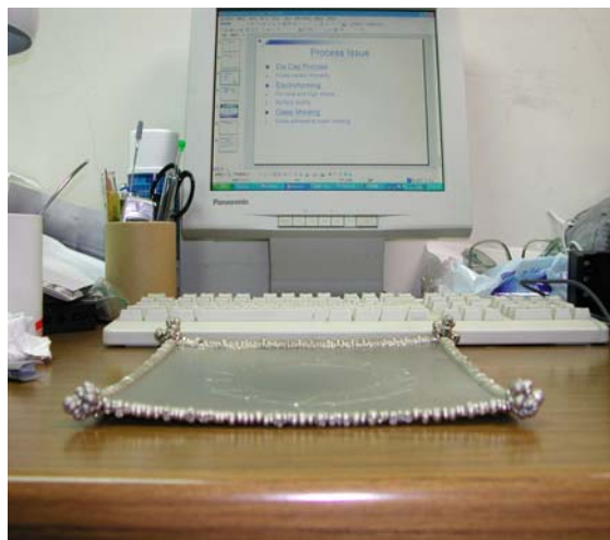
圖 3.11 電鑄鍍板因內應力過大而彎曲
