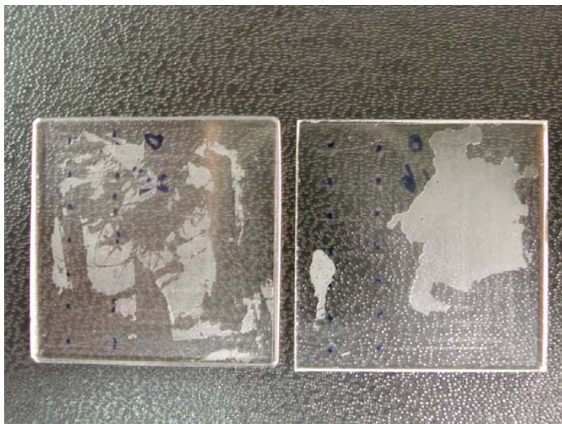
圖 3.25 部分材料因研磨而完全脫落
