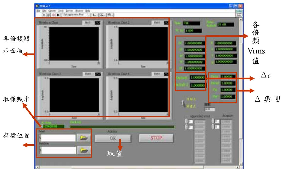
圖 B-3 改寫 LockinDEMOSimple.vi 程式的前置面板圖
