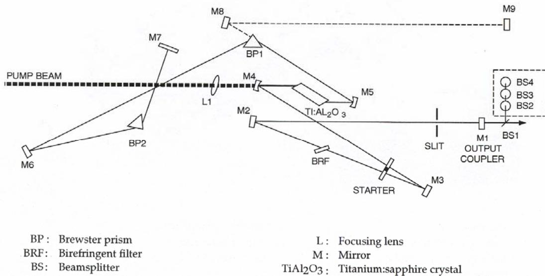
圖 2-6. Model 900-D Mira 儀器配置圖。
