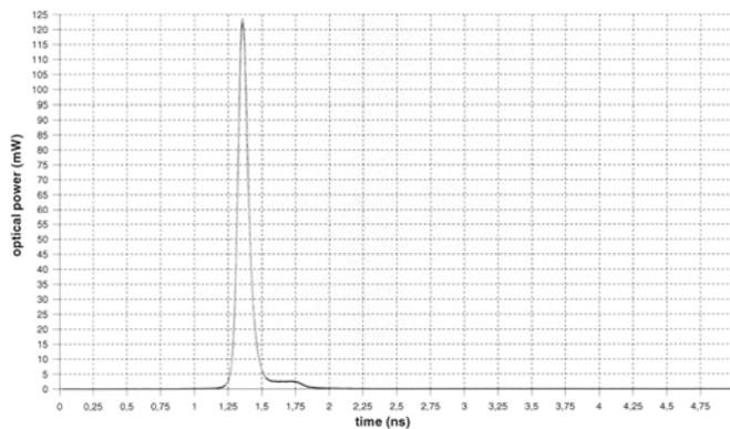
圖 2-10. (C) LDH-P-C 635B 的儀器相關函數。此時雷射光源平均功率為 0.53 mW，脈衝重複頻率為 40 MHz，半高寬為 88 ps。
