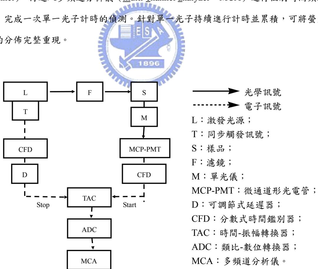
圖 2-3. TCSPC 模組之訊號擷取及計時程序。
