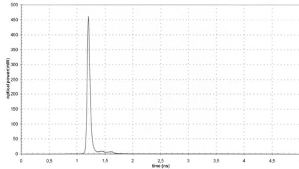
圖 2-10. (A) LDH-P-C 400 的儀器相關函數。此時雷射光源平均功率為 130 mW，脈衝重複頻率為 40 MHz，半高寬為 54 ps。
