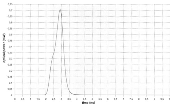
圖 2-10. (D) PLS 500 的儀器相關函數。此時雷射光源平均功率為 20 $\mu$ W，脈衝重複頻率為 40 MHz，半高寬為 635 ps。
