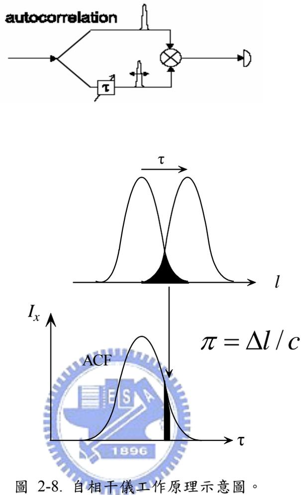
圖 2-8. 自相干儀工作原理示意圖。
