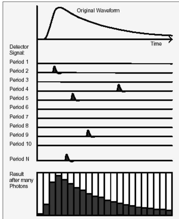
圖 2-1. TCSPC 的工作原理。
