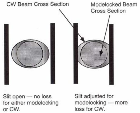
圖 2-4. 克爾透鏡鎖模的脈衝壓縮機制：(A) 光束幾何圖形； (B) 光束橫切面示意圖。
