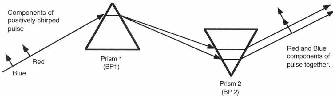
圖 2-5. (A) 不同波長的電磁波通過介質時，所對應的折射率  $n$  值不同。 (B) 群速度色散的補償。
