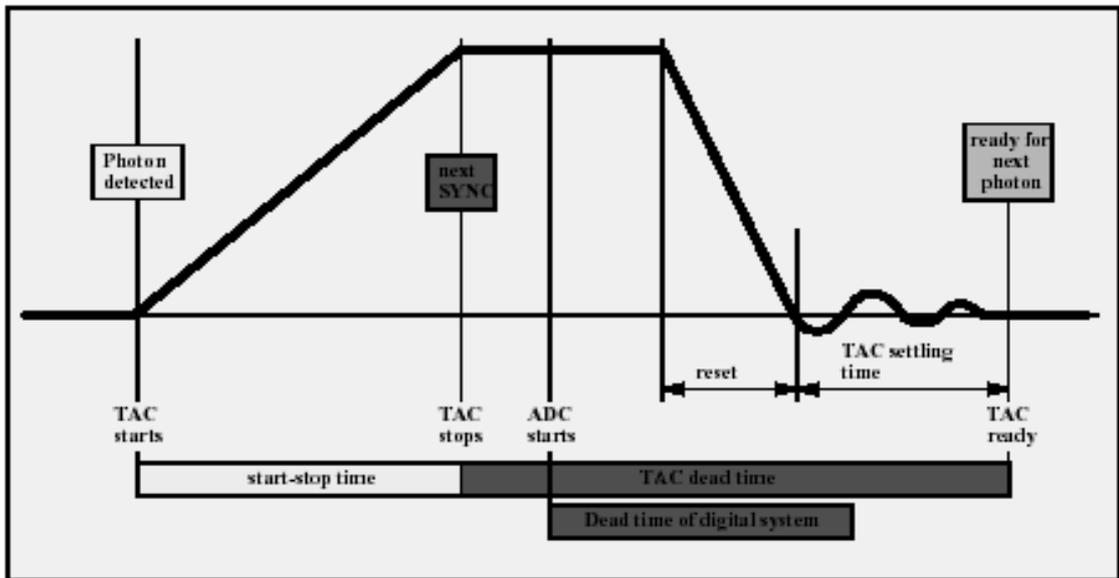
圖 2-13. TAC 偵測單一光子的計時機制。
