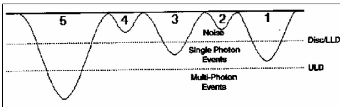
圖 2-11. 當輸入鑑別器的訊號低於一特定門檻的電壓高度時，則被分數式時間鑑別器視為雜訊去除。
