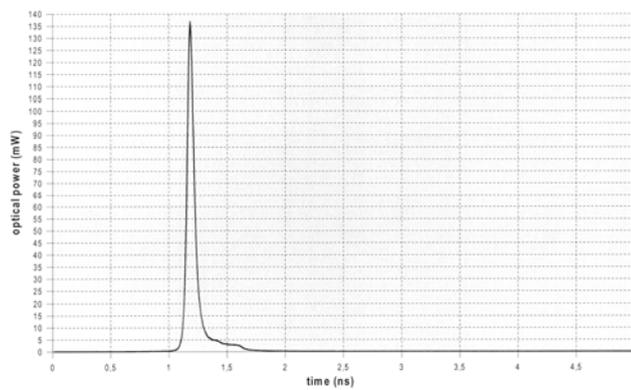
圖 2-10. (B) LDH-P-C 435 的儀器相關函數。此時雷射光源平均功率為 0.5 mW，脈衝重複頻率為 40 MHz，半高寬為 63 ps。
