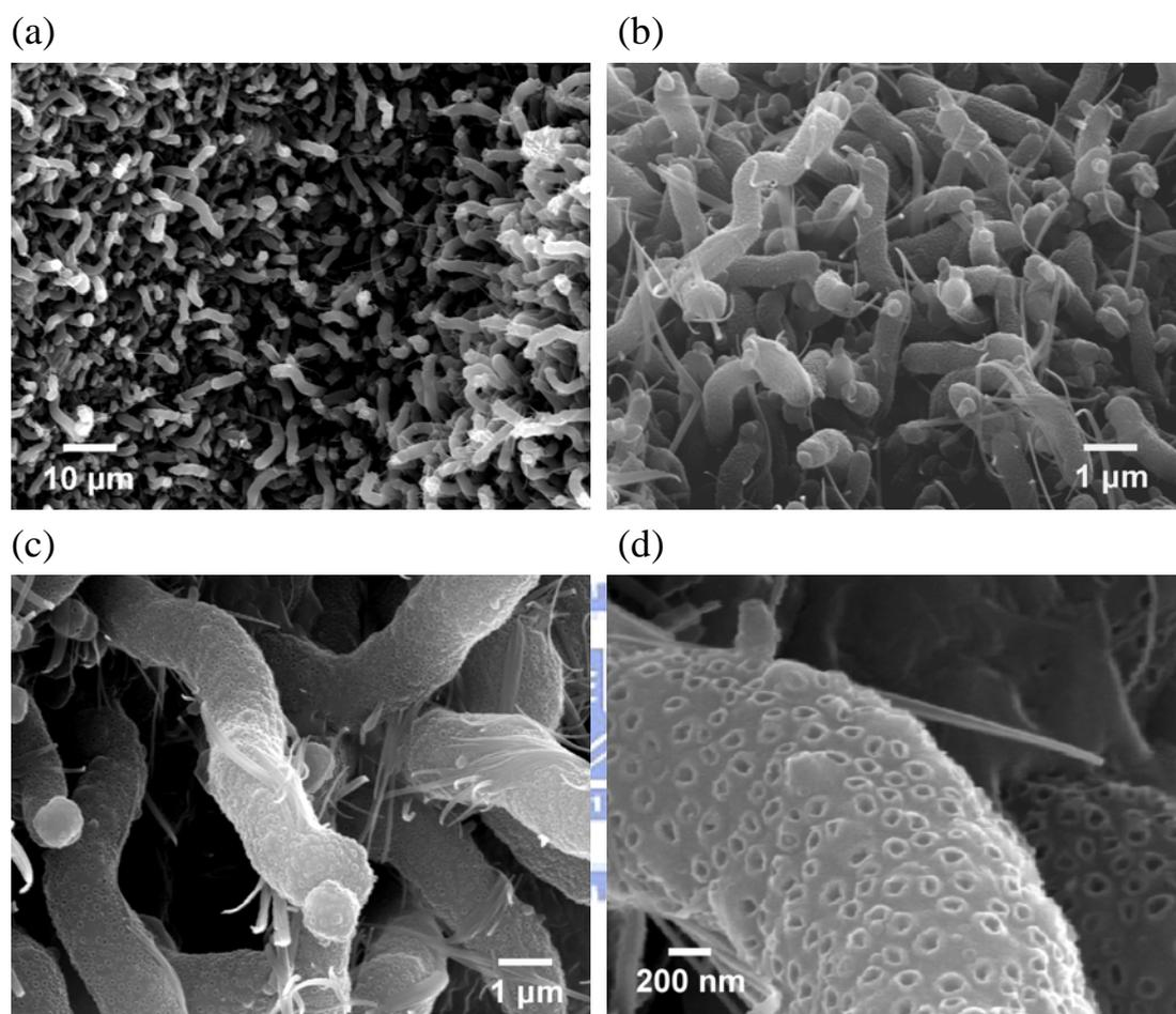
圖十九. 樣品 E，類型 E2，以乙炔與氫化鈉反應所得的一維碳材之掃描式電子顯微鏡影像圖。
