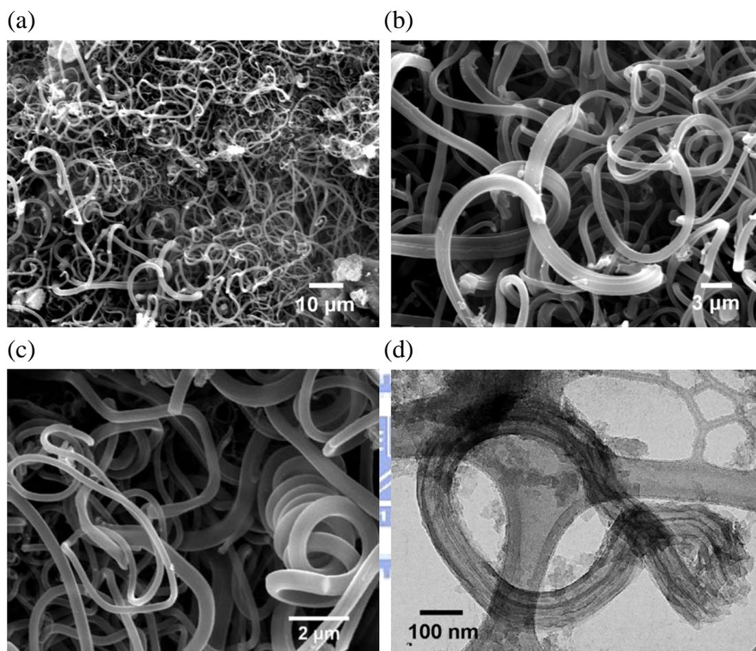
圖二十一. 樣品 F，類型 F1，以乙炔與鈉金屬反應所得的一維碳材之掃描式電子顯微鏡影像圖，(d)為 TEM 影像圖。
