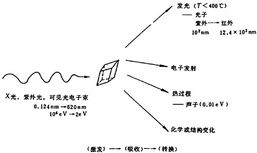
圖 1 激發能在發光材料中的吸收與轉換
