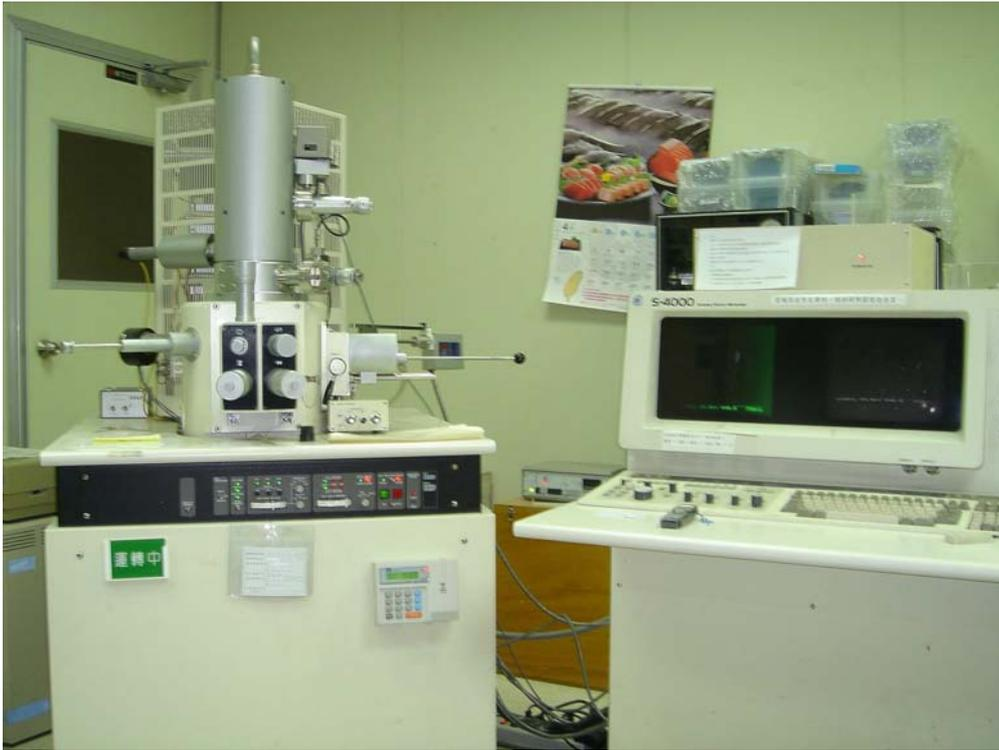
圖 29 Hitachi S-4000 型掃描式電子顯微鏡
