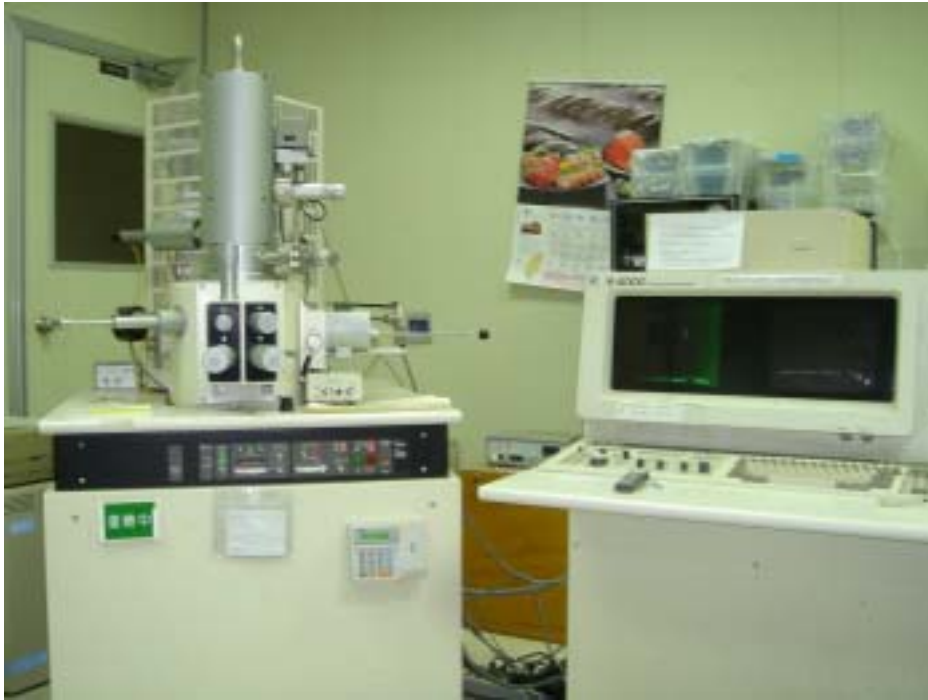
圖 26 Hitachi S-4000 型場發射掃瞄式電子顯微鏡
