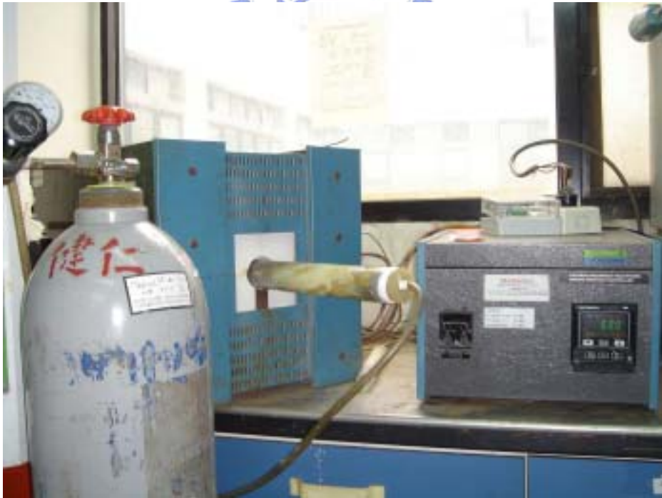
圖 22 美國 Lindberg 公司製造之 51442 型程式控溫管狀爐
