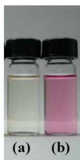
圖一〇一、(a) 對位甲氧基偶氮苯下緣雙四唑芳杯 264a ( 10 \mu\text{M} ) 在 \text{CH}_3\text{CN} 中，與 (b) 加入 5 當量的 \text{Ca}^{2+} 離子之顏色變化。
