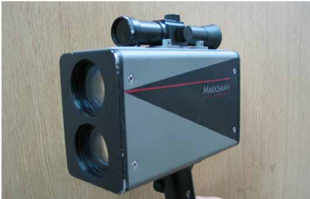
圖 3-6 MARKSMAN LTI 20-20 雷射測速槍
