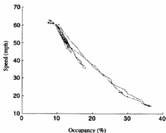
圖 2.5 速度與密度隨時間而變動的圖形
