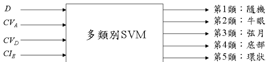
圖 3.5 本研究之多類別 SVM 晶圓缺陷樣式辨識系統架構圖
