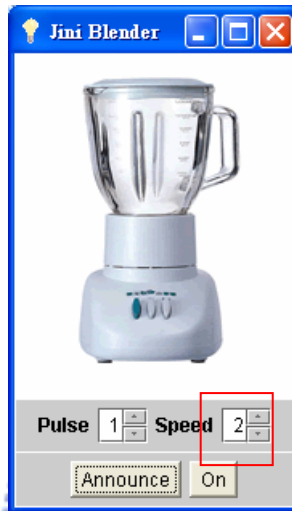
圖 5.30 進行遠端呼叫後，Jini 果汁機設備搖動速度會改變為 2
