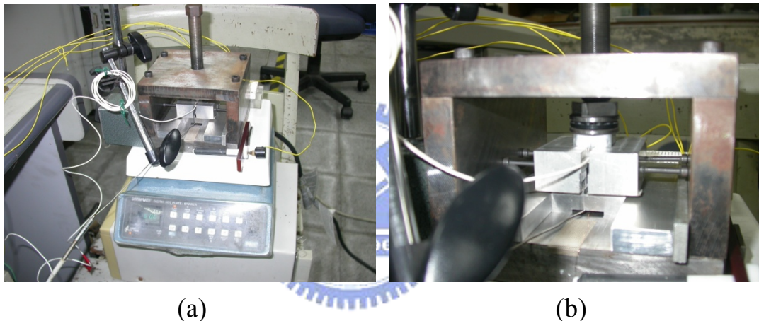
圖 66 實際晶片壓應力對電阻值關係的測試裝置。
