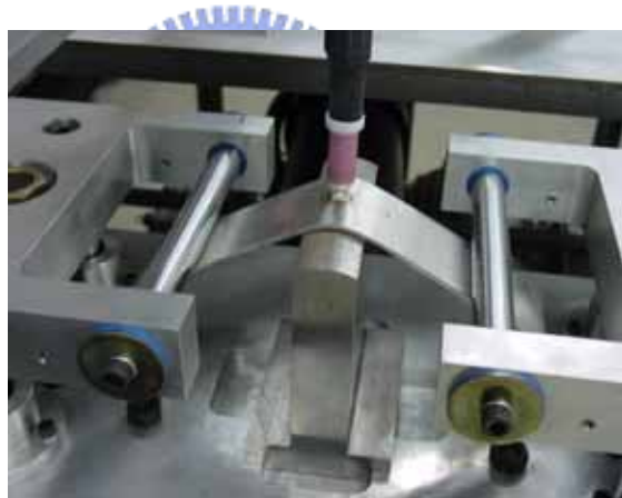
圖 2-16 多功能可調應變試驗機試驗情形
