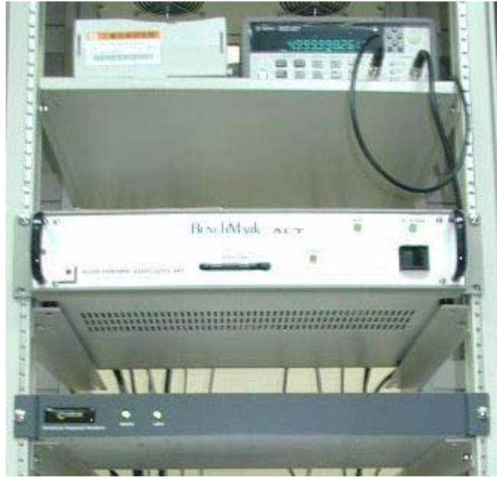
圖 4-1 TNML 站所使用的 GPS 接收儀及銣原子鐘
