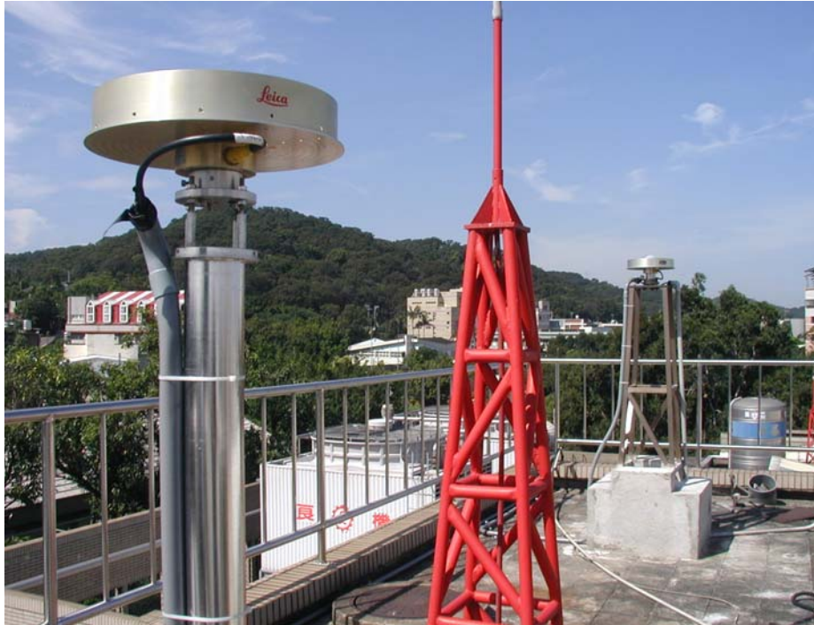
圖 5-1 固定基站基樁設置型式
