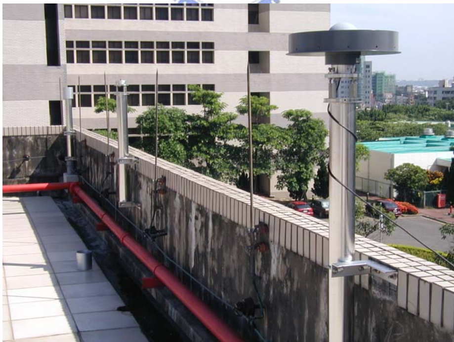
圖 5-2 校正基點 NML3&4&5 基樁設置型式
